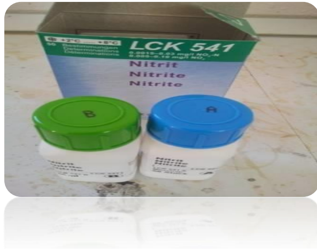
Figure 16 : Le Kit duré actif spécifique aux ions nitrite(LCK541)
