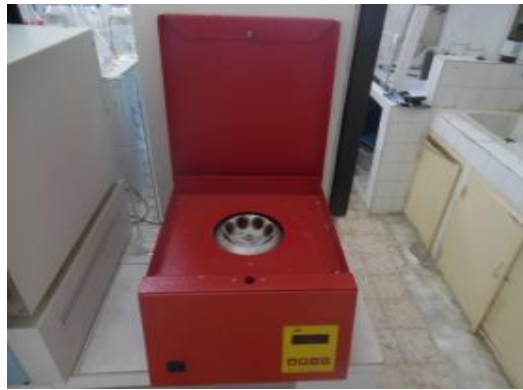
Figure 34. Centrifugeuse utilisée dans la mesure du taux de matière grasse
