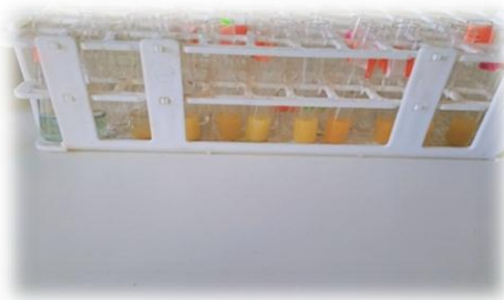
Figure 15 : Intensité de la coloration lors du dosage des protéines des confitures de raisin après 30 min (Dziri, 2023).
