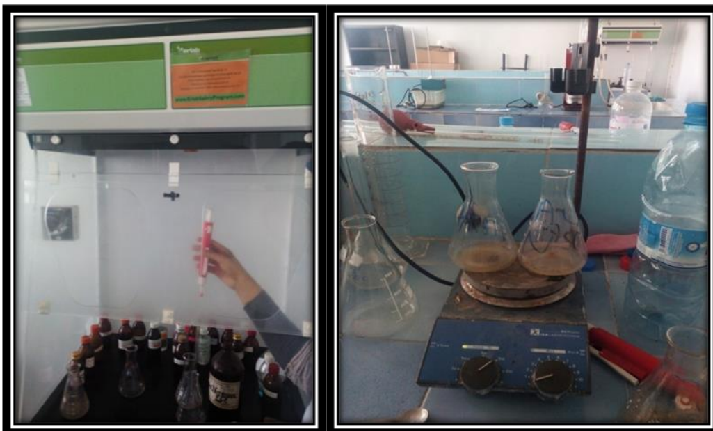
Figure 8. Titration des chlorures
