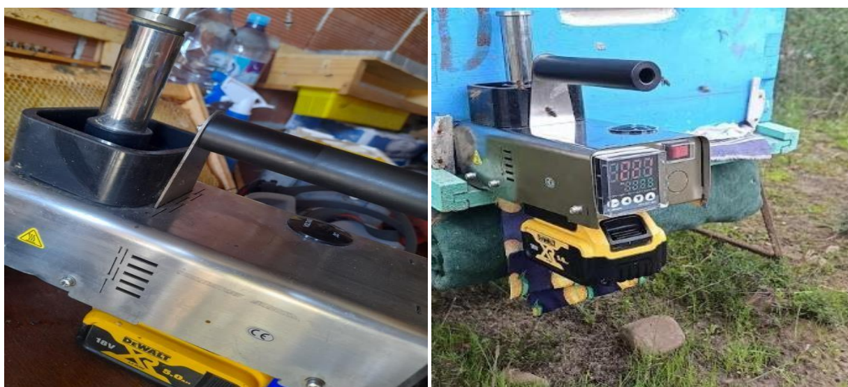
Figure n°38 : Vaporisateur d'acide oxalique (Fellah Ibtissem, 2026)
