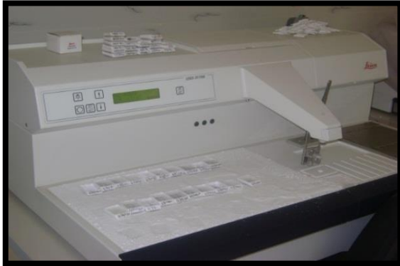
Figure 17 : Microtome pour la coupe des bandes Figure 18 : Mise des coupes sur des lames en verre
