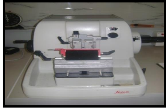
Figure 17 : Microtome pour la coupe des bandes Figure 18 : Mise des coupes sur des lames en verre
