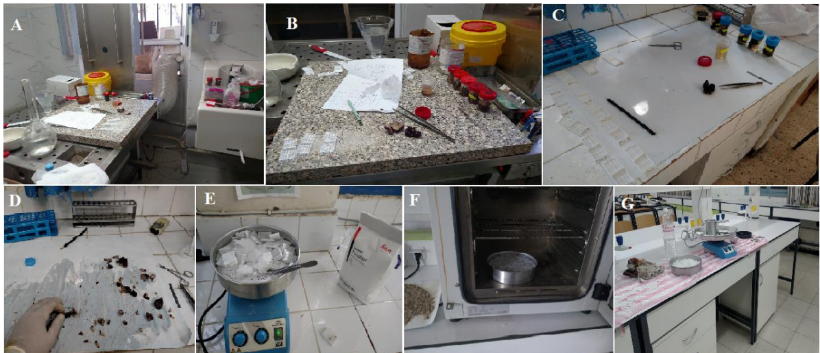
Figure 38. Principales étapes de préparation des échantillons en blocs de paraffine. A et B : unité anatomie-pathologie CHU d'El -Tarf ; C, D, E, F et G : Laboratoires de l'université de Badji-Mokhtar Annaba.
