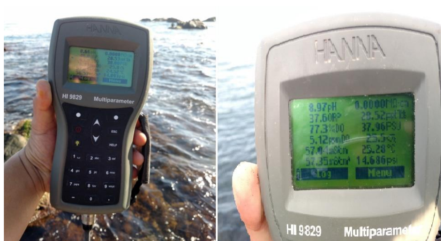
Figure 21. Mesure des paramètres physicochimiques des eaux de surface (Cliché : Zerarguia, 2017)
