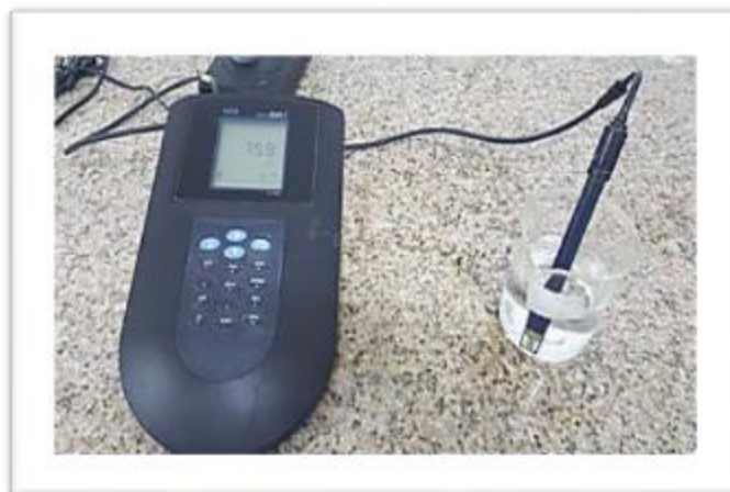
Figure 05 : pH mètre (BOUTELDJI& MELLOUK, 2021).
