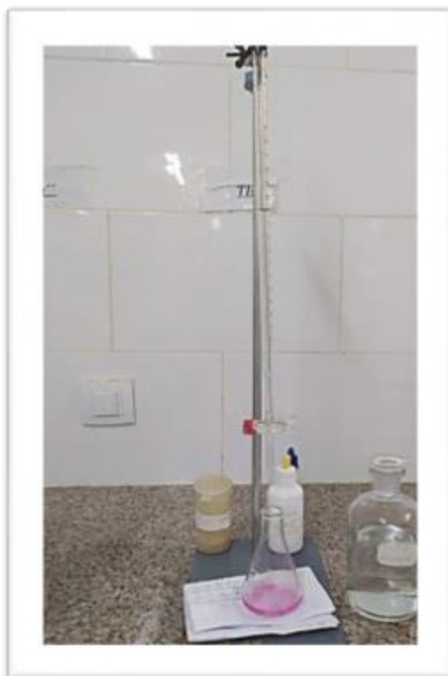
Figure 10 : Dosage de \text{Ca}^{2+} (BOUTELDEJI & MELLOUK, 2021).
