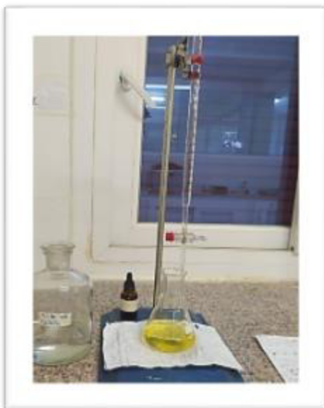
Figure 08 : Dosage de TAC (BOUTELDJI& MELLOUK, 2021).
