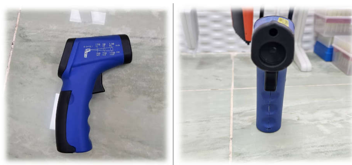
Figure 17: Détecteur à infrarouge de la température de la litière. (Arioua, 2023)
