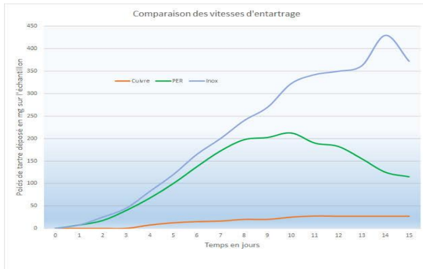
Figure N°05: Comparaison des vitesses d'entartrage entre les différents types de matériaux constituant des canalisations [21].
