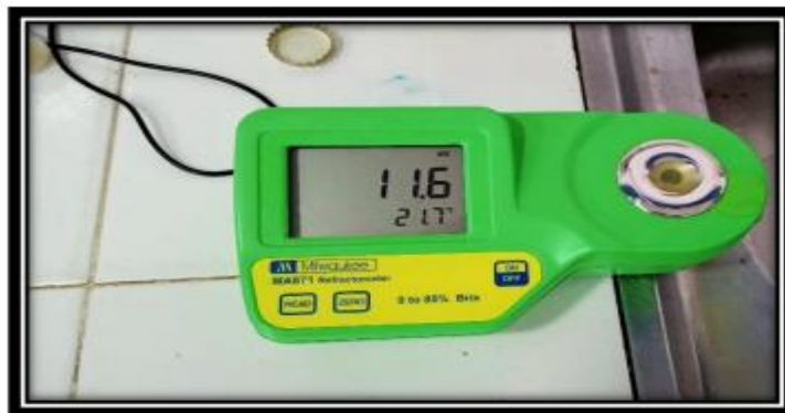
Figure 23 : Réfractomètre numérique affichant le degré Brix et la température d'un échantillon du jus au lait
