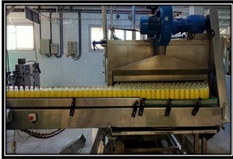
Figure 16 : Fin du tunnel de refroidissement (Salhi Z., 2023)
