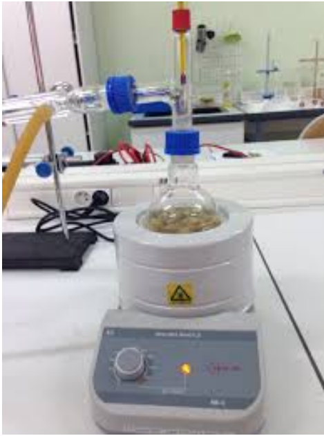
Photo 5 : Montage du Clevenger pour l'extraction d'huile de gingembre.
