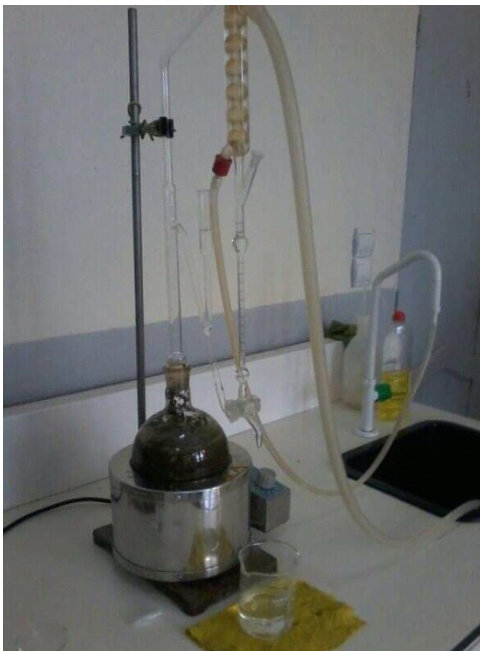
Photo 4 : Montage du Clavenger pour l'extraction d'huile de laurier
