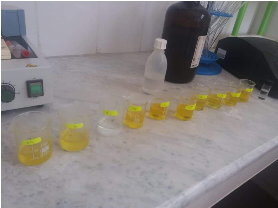
Photo 03 : Phase préparatoire des échantillons pour la lecture par spectrophotomètre, le virage de couleur en jaune indique la présence de nitrate
