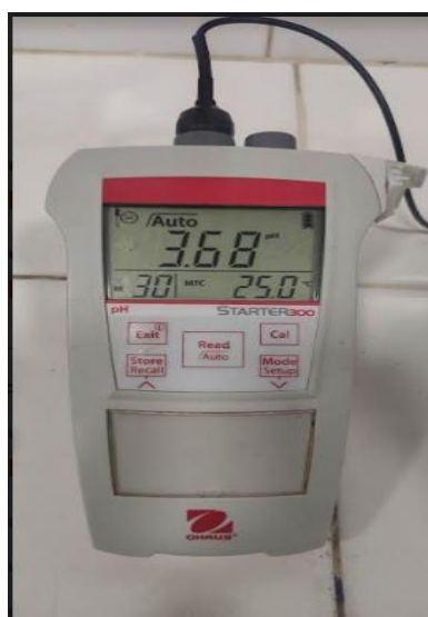
Figure 24. Résultat de mesure du pH d'un échantillon (Boumaza S., 2026).
