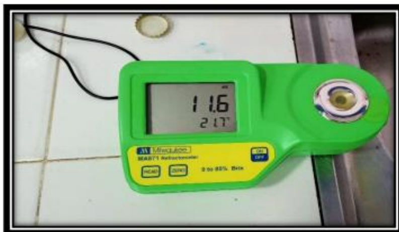
Figure 22. Réfractomètre numérique affichant le degré Brix et la température d'un échantillon du jus (Boumaza S, .2026).
