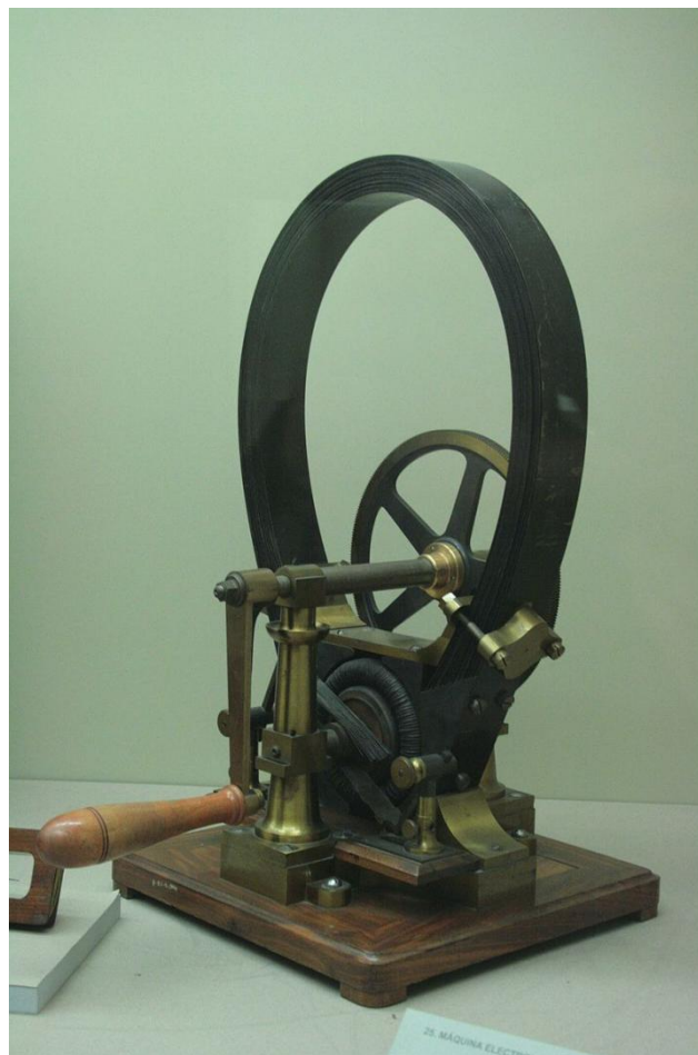
Figure 1.2:Dynamo Gramme (modèle de 1878) [6]
