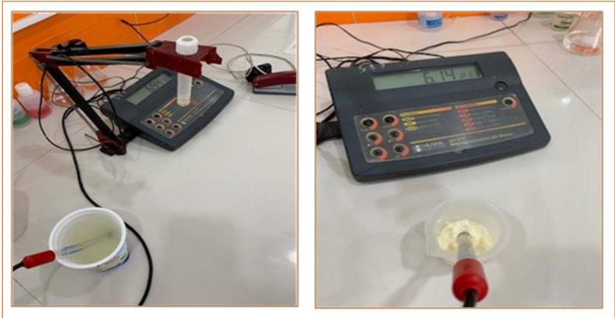
Figure .4. Appareil du pH-mètre électronique (HI2210 HANA instrument) pour mesurer le pH du lait cru et des produits laitiers (Photos Mahmoudi, 2024).
