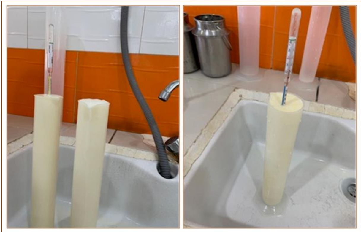
Figure .6. Mesure de la densité du lait par lactodensimètre (Photos Mahmoudi, 2024).
