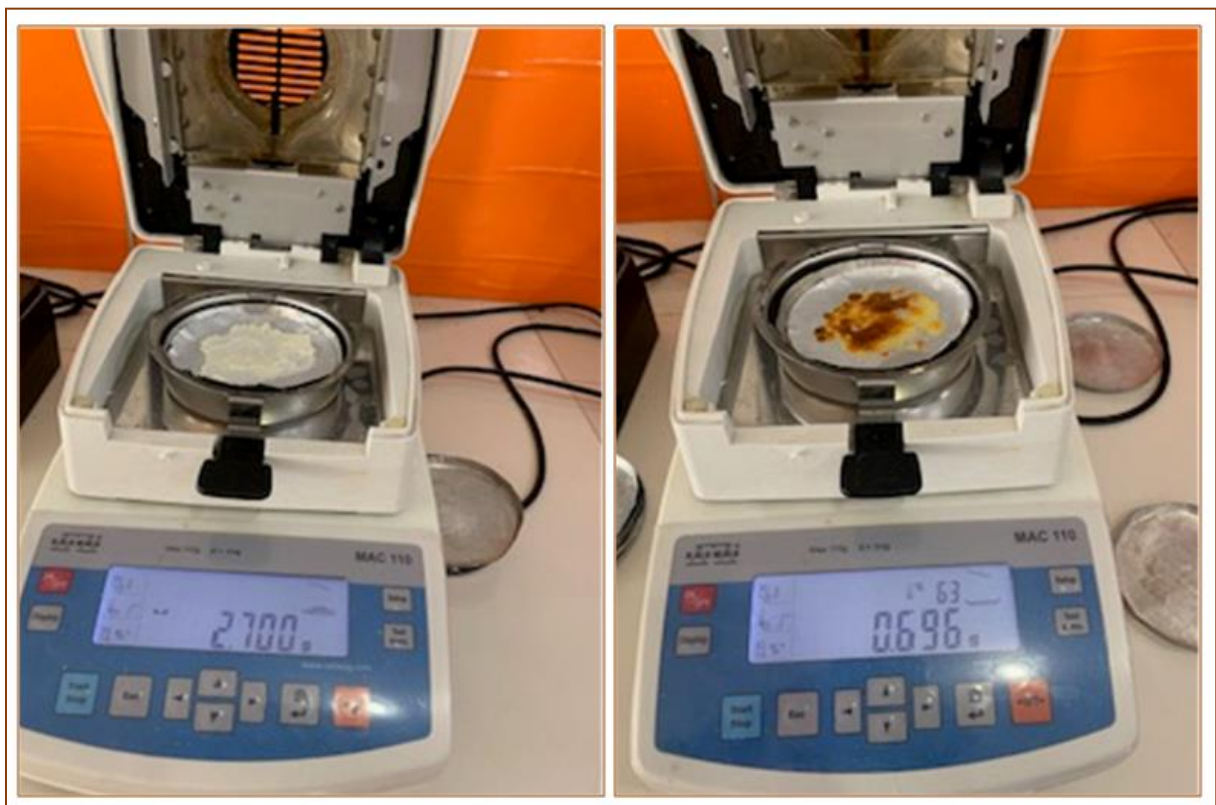
Figure .7. Mesure de la matière sèche totale du lait et du fromage (Photos Mahmoudi, 2024).
