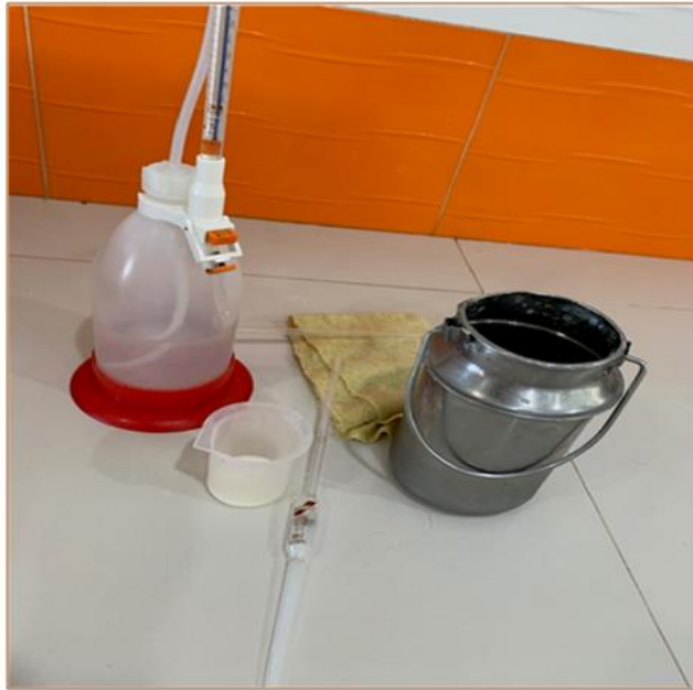
Figure .5. Mesure de l'acidité par la burette avec le titrage de la solution d'hydroxyde de sodium (Photo Mahmoudi, 2024).
