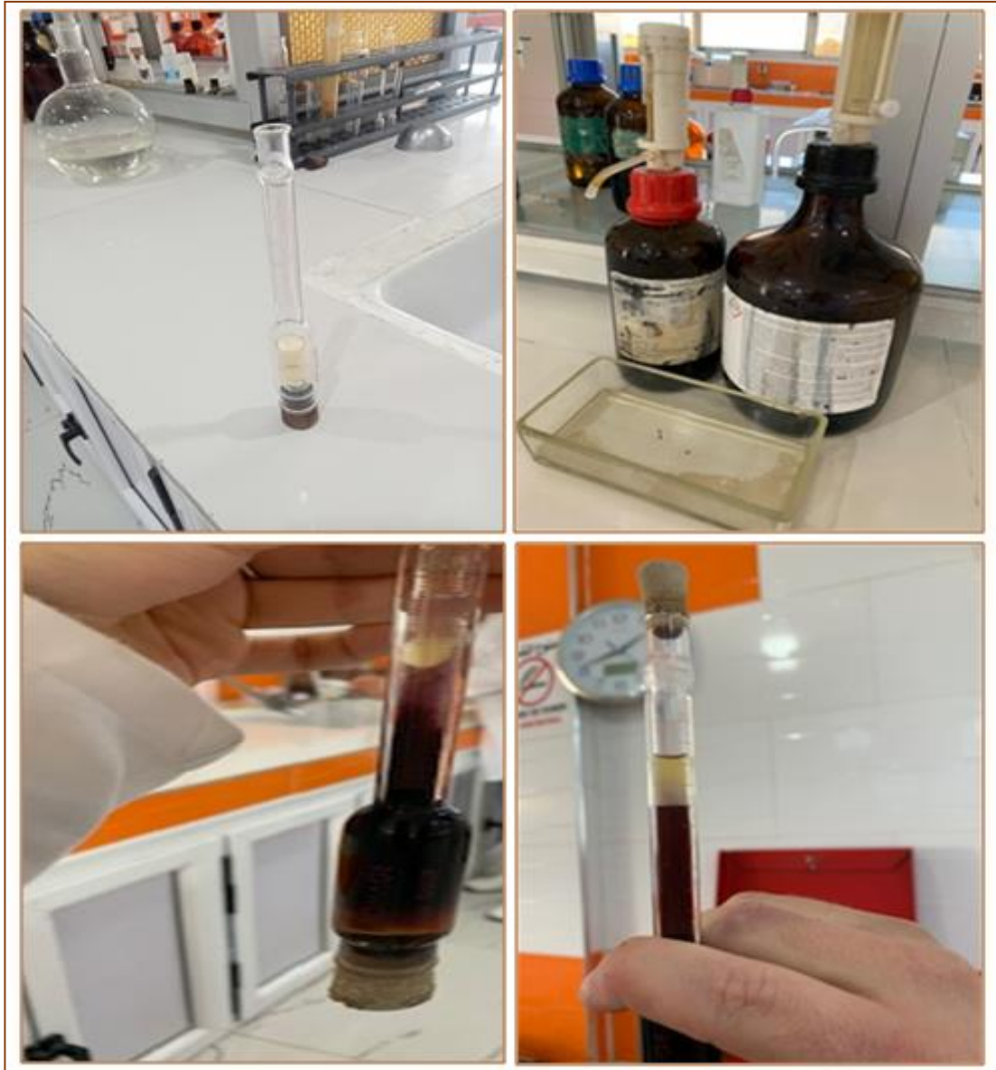
Figure .8. Mesure de la matière grasse (Butyromètre, Acide, Alcool iso amylique) (Photos Mahmoudi, 2024).
