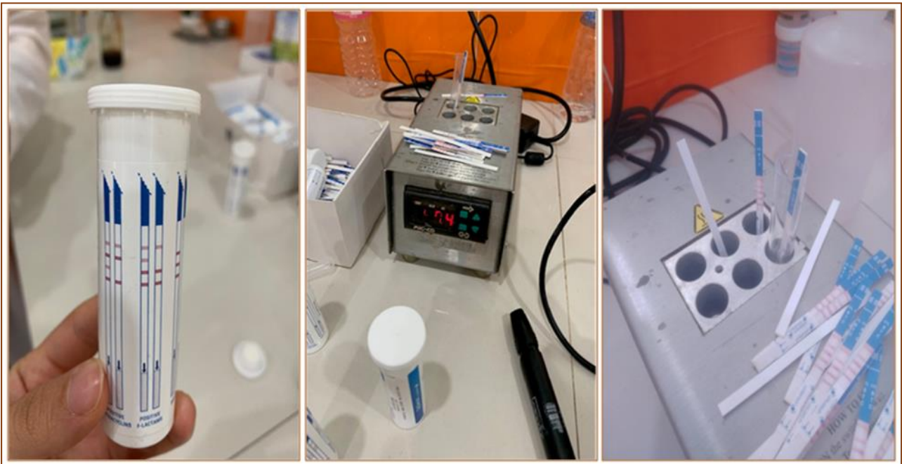
Figure .9. Le test antibiotique ou résidus antibiotiques par l'utilisation de l'appareil ROSA incubateur et les bandelettes de migration (Photos Mahmoudi, 2024).
