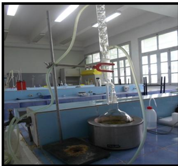
Photo 1 : hydrodistillateur de type Clevenger
