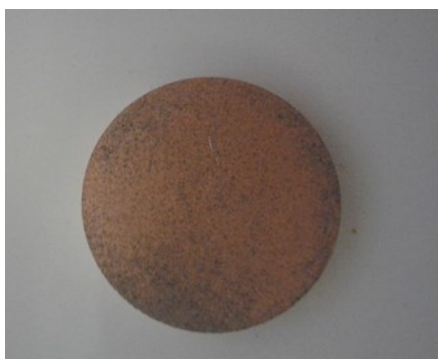
Figure II.8: Echantillon cru après pressage uniaxial.
