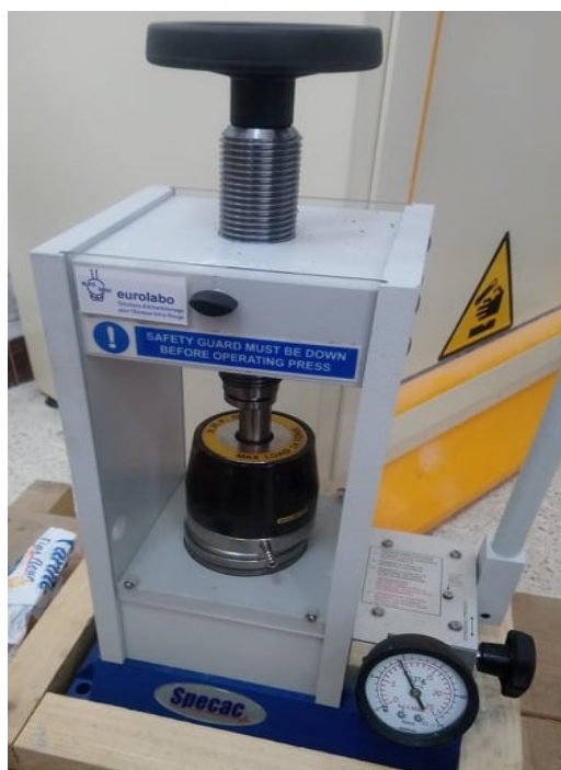
Figure II.7: Pressage uniaxial à froid avec la matrice cylindrique
