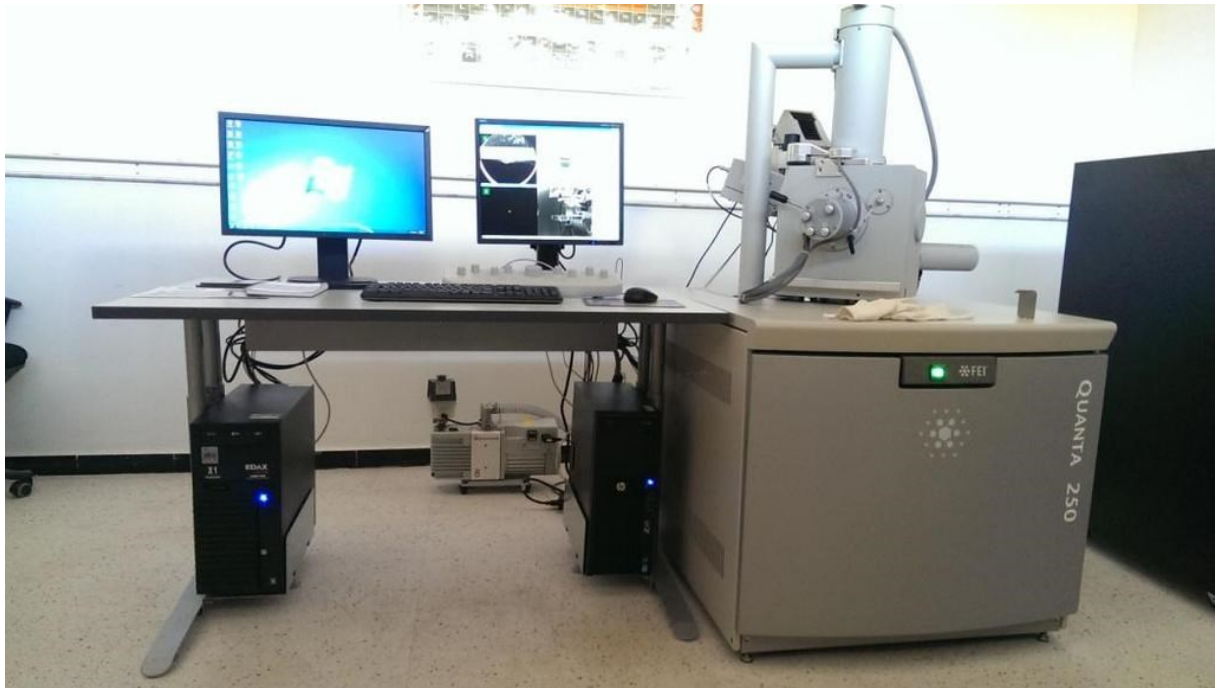
Figure II. 12. Microscopie électronique à balayage MEB de type Quanta 250– FEI équipé d'un détecteur de spectroscopie à dispersion d'énergie (EDS).
