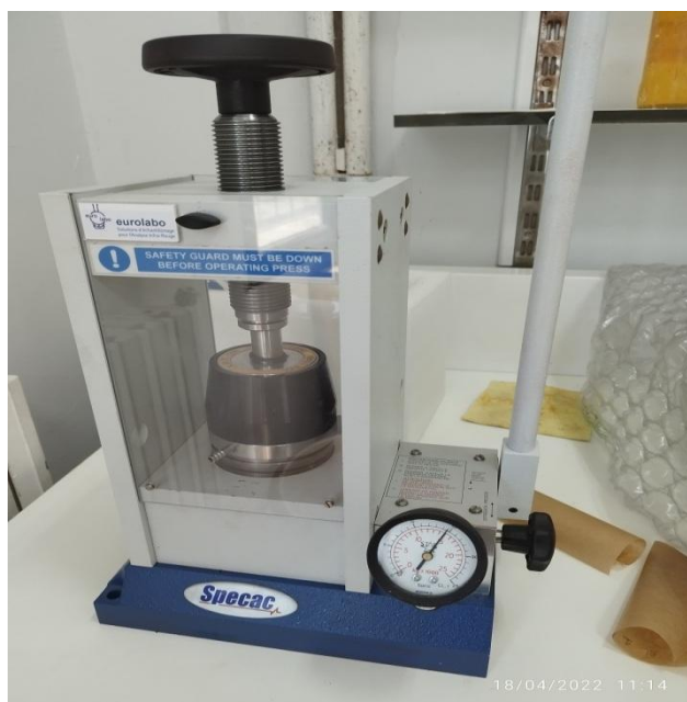
Fig II.7: Presse hydraulique uniaxiale de type SPECAC.
