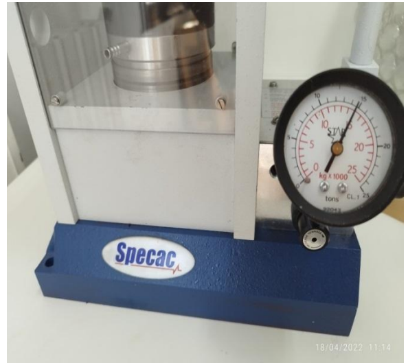
Fig II.9 : Compactage uni axiale du comprimé à une pression de 15 tonnes.
