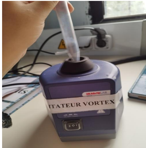
Fig II.5 : Agitateur des poudres DRAGON-LAB MX-F.
