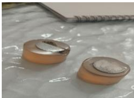
Fig II.23 : Les échantillons après découpage et enrobage.
