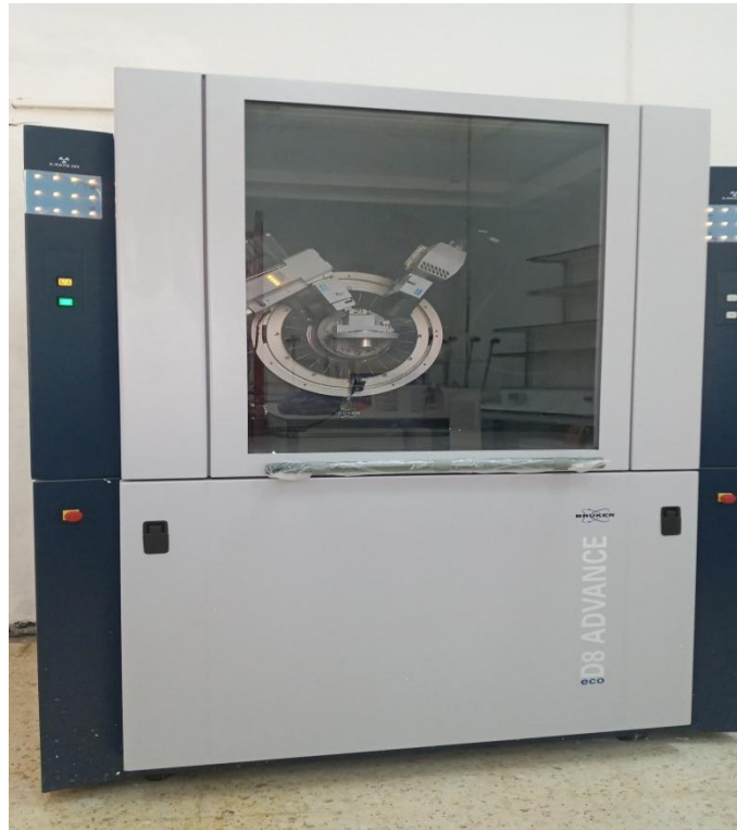
Fig II.18: Diffractomètre D8 ADVANCE –ECO.
