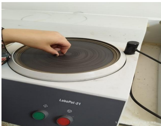
Fig II.19 : Polissage à l'aide d'une polisseuse automatique double disques.
