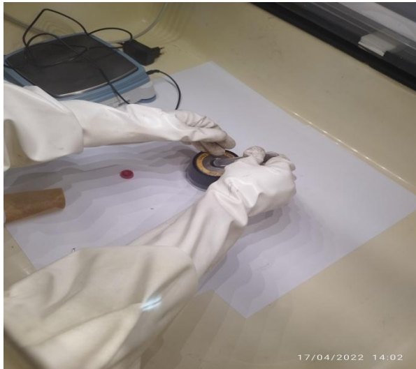
Fig II.8 : Préparation de la matrice de compactage.
