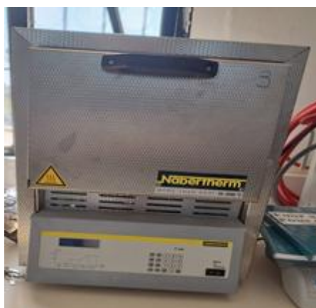
Fig II.11 : Le four utilisé dans l'opération de frittage de la marque NABERTHERM.
