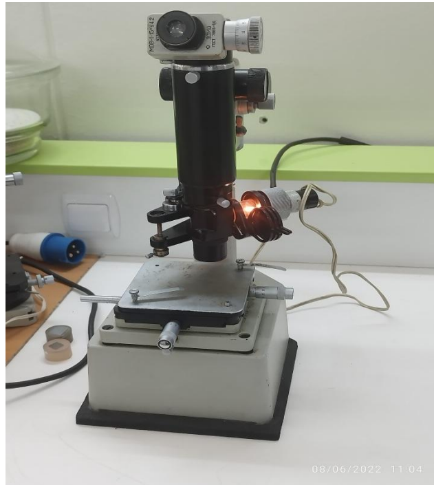
Fig II.27 : Microduromètre de marque ROMO GOST 7865-56.
