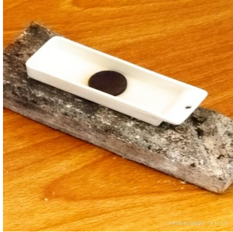
Fig II.15 : L'échantillon dans le creuset après frittage refroidit à l'air.
