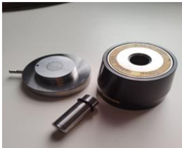
Fig II.6 : L'ensemble de la matrice du compactage.
