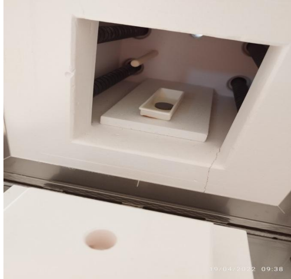
Fig II.12 : Mise en place de l'échantillon dans l'enceinte du four.
