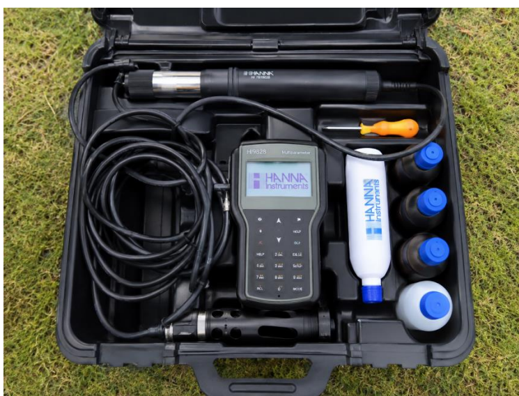
Figure 5. Valise multiparamètres portable HANNA Instruments HI9828 utilisée pour les mesures physico-chimiques in situ (SAADI, 2026).
