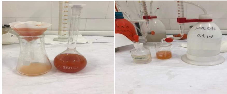
Figure II.10 Filtration et titrage avec NaOH.
