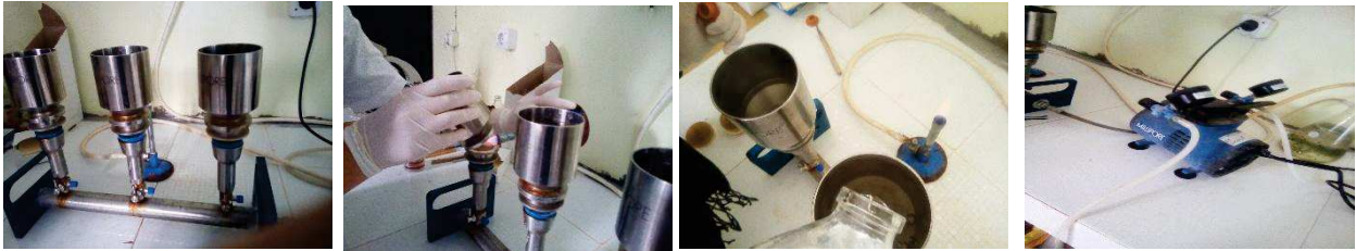
Figure n° 08. Le principe de la technique de culture sur membrane.
