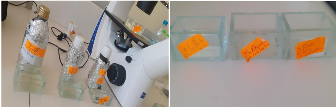
Figure 12: Les chambre de décantation (Photo pers.,2022).
