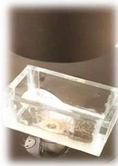
chambre de décantation
