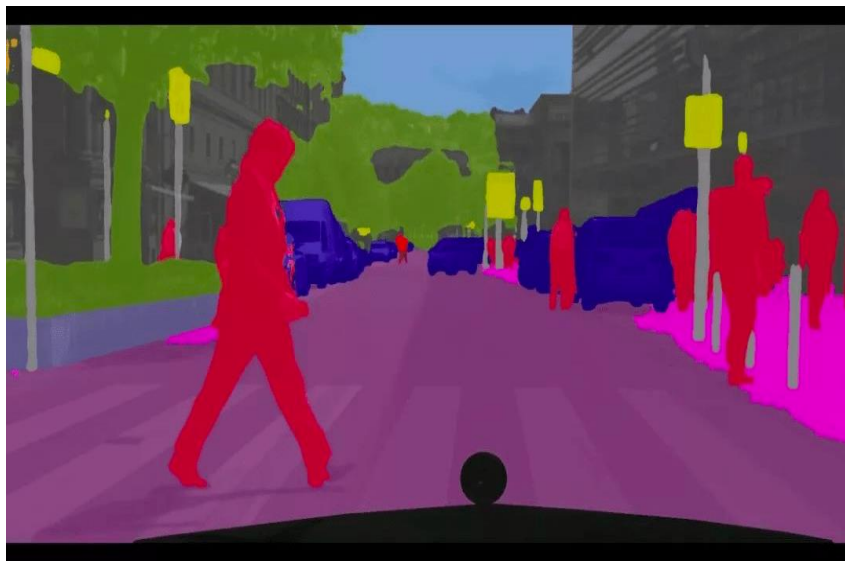
Figure1-21-Exemple d'opération de segmentation d'image[f08].
