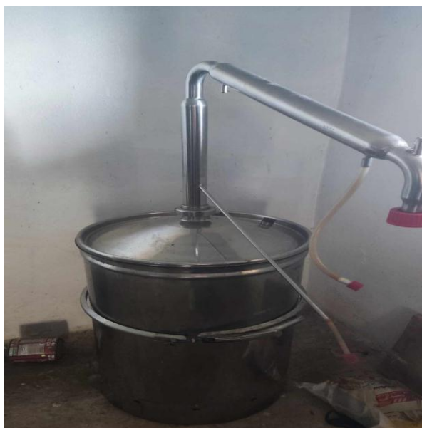
Figure 10. Montage utilisé pour l'extraction des huiles essentielles (Alleg, S. 2024).
