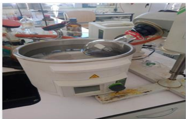
Photo III.3 : Montage d'évaporation (AROUCI Romaiassa 2023)
