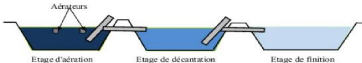
Schéma III.7. Représenté le principe de lagunage aéré. (Molleta, R, 2006)
