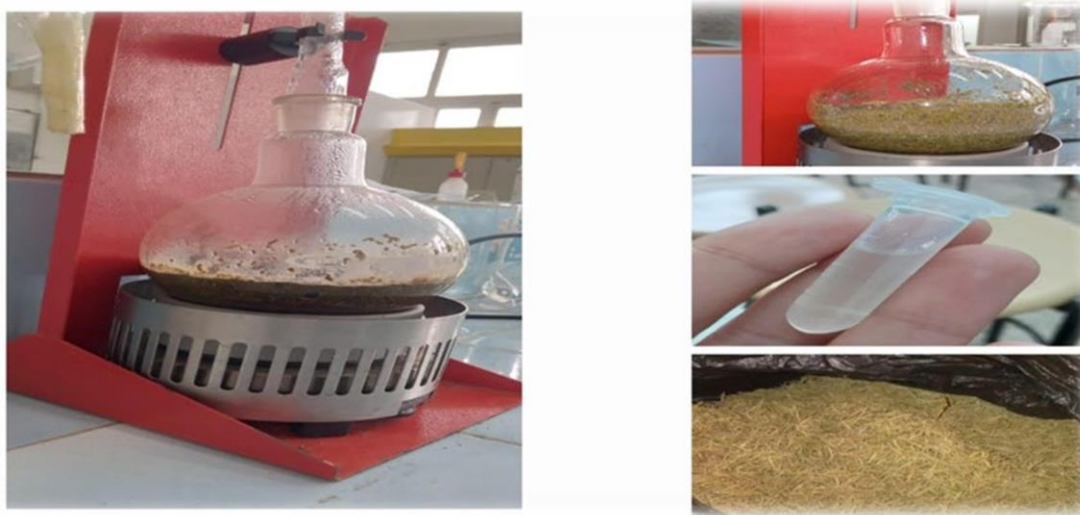
Figure 14 : Extraction des huiles essentielles par hydrodistillation à l'aide d'un appareil de type Clevenger
