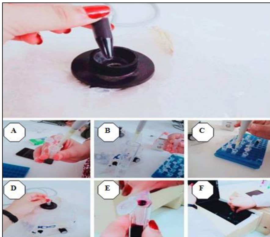
Photo 26: Méthode de l'activité antioxydante (A : DPPH+méthanol B: dilution de l'HE, C: HE dilué, D: agitation, E: Mettre le DPPH dans la cuve, F: lecture au spectrophotomètre (Bouchair et Tahri, 2021).
