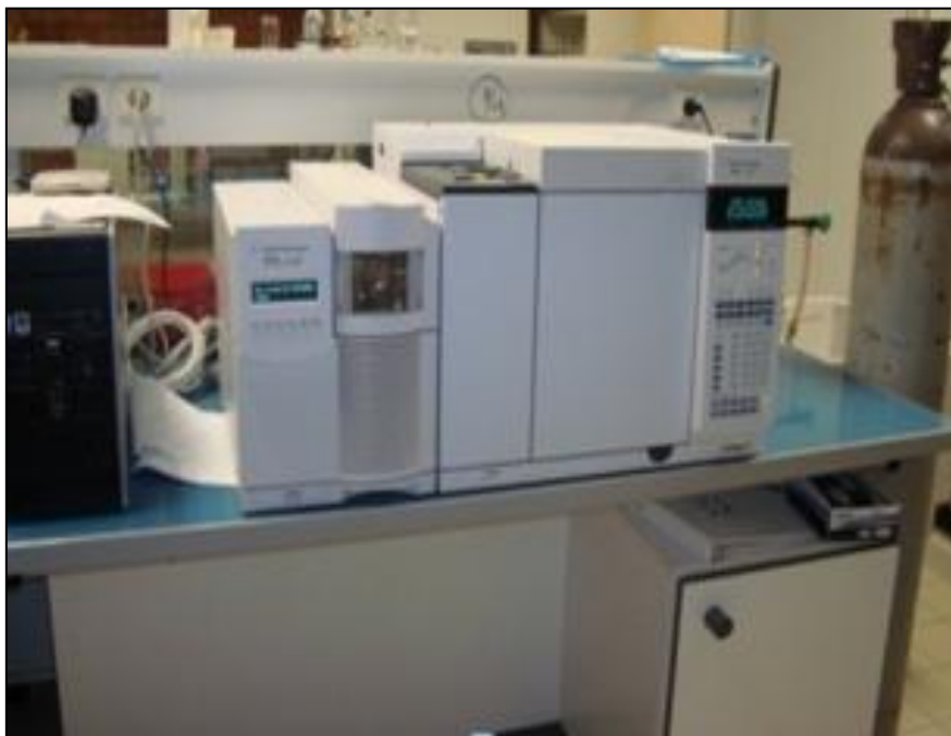
Figure 04: Couplage chromatographie en phase gazeuse/Spectrométrie de masse (Benabdallah, 2016).
