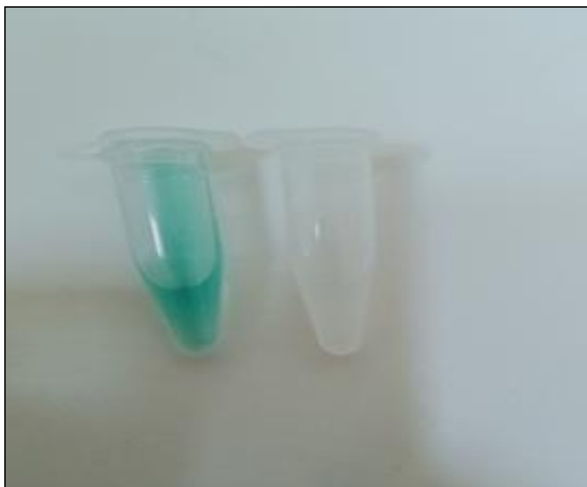
Photo 39: Décoloration de l'ABTS en présence d'un antioxydant
