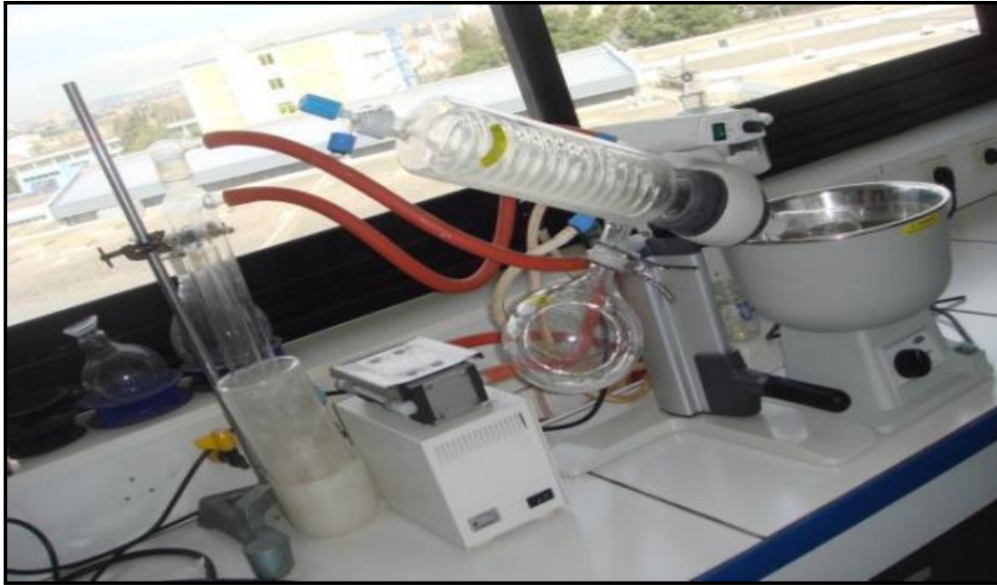
Photo 11 : Séparation de l'huile du solvant par rotavapor ( Janvier, 2020 ).
