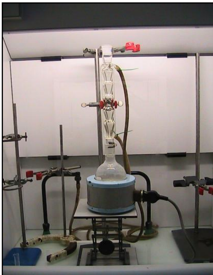
Photo 9: Extraction par Soxhlet (Janvier, 2020).
