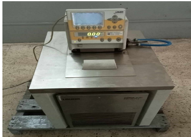
Fig. III.11. Dispositif de refroidissement des éprouvettes « CROIS_THERMOSTA ».
