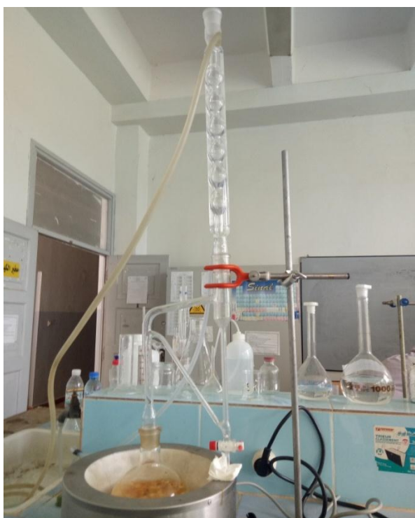
Photon 6: Appareil d'hydrodistillateur de type Clévenger (Original, 2022) laboratoire pédagogique de Phytochimie.
