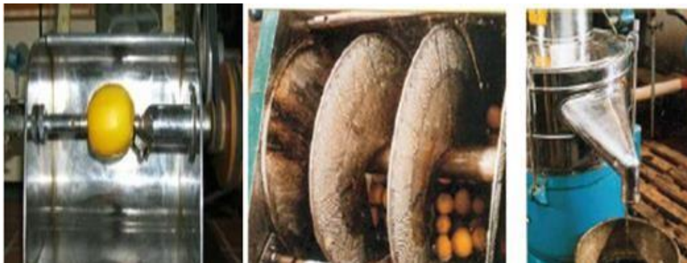
Figure 2: dispositif de l'expression à froid.
