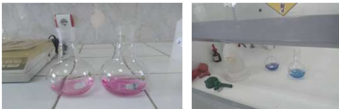
Photo. III. 7 : Détermination de calcium (Merdaci Rayane 2024).
