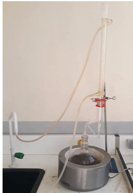
Photo n°06 : Montage d'hydrodistillation (Tarfi Djihene, 2020).
