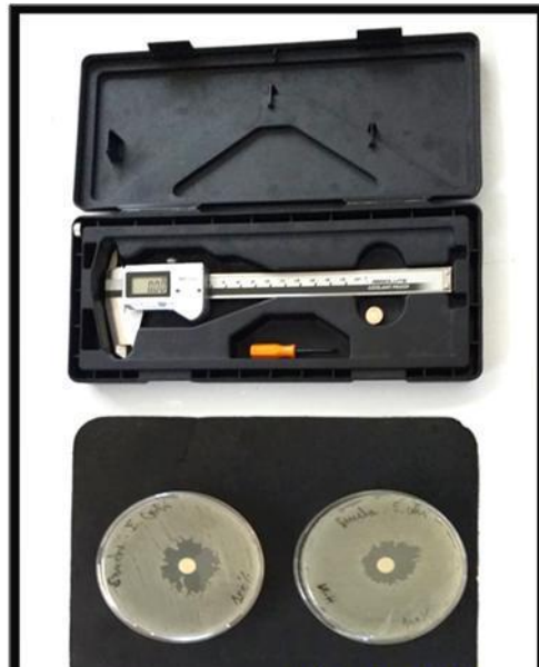
Photo n°20: Lecture diamètre d'inhibition à l'aide d'un pied à coulisse.
