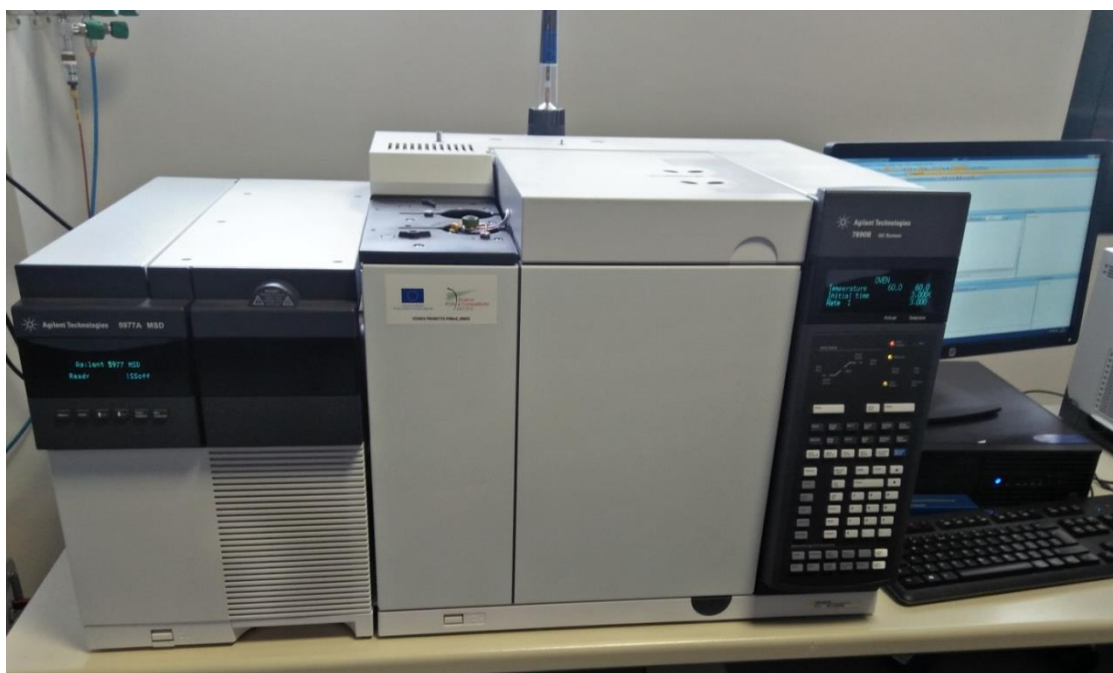
Figure 26. Dispositif de la spectrométrie de masse en couplage avec la chromatographie en phase gazeuse
