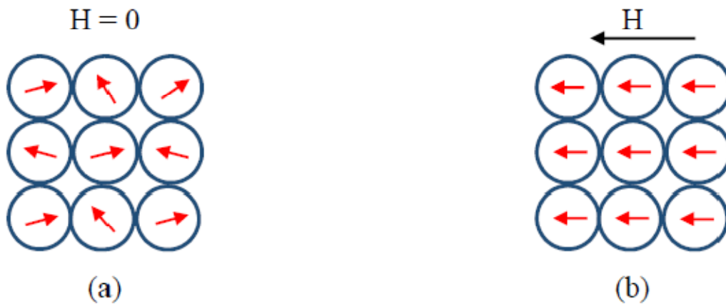
Figure I.10 : Matériau paramagnétique : (a) en l'absence du champ (b) en présence du champ H externe
