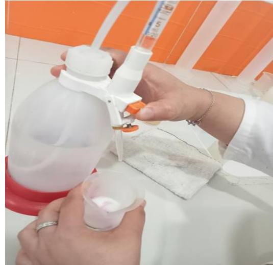
Figure 02 : Mesure de l'acidité du lait cru (Athamnia F , Bouamrane A 2023)
