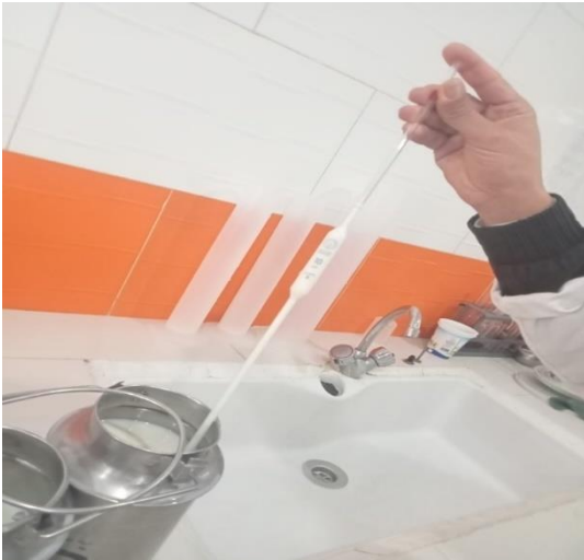
Figure 02 : Mesure de l'acidité du lait cru (Athamnia F , Bouamrane A 2023)
