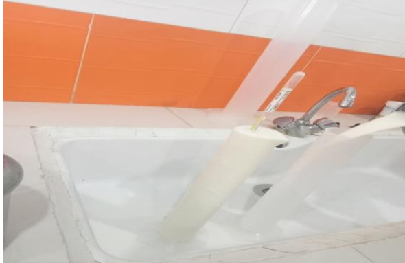
Figure 03: Mesure de la densité de lait cru (Athamnia F , Bouamrane B 2023)
