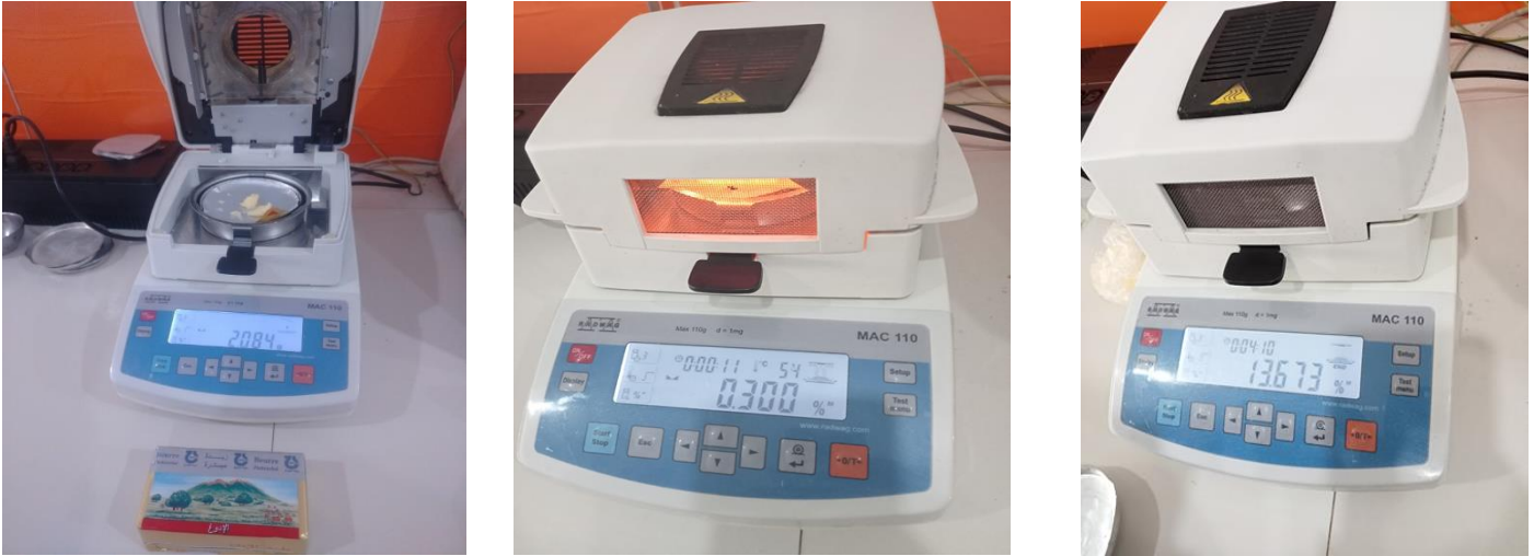
Figure 07: Détermination de l'extrait sec (Athamnia F, Bouamrane A 2023)
